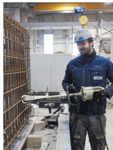
Patrick Kleinhans vom Bernhard Müller Betonsteinwerk in Achern bei der Arbeit mit dem Krenn Stahlschneider.
