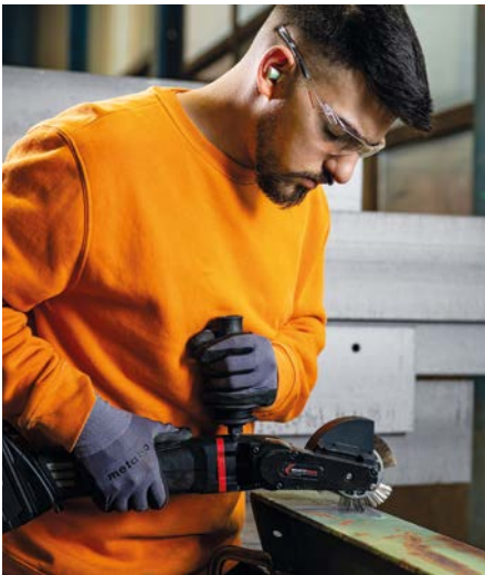
Kabelloses Entfernen von Korrosion, Beschichtungen oder Rost mit dem Montipower Bristle Blaster Cordless.
