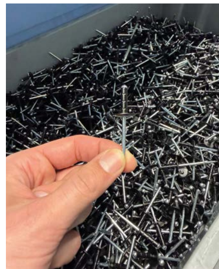
Blindniete aus deutscher Herstellung: Diese Mehrbereichs-Blindniete werden von Goebel am Standort Erkrath bei Düsseldorf produziert.
