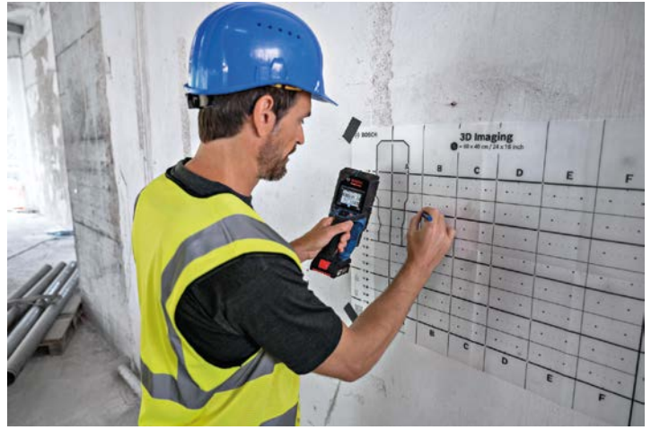
Der Wandscanner EXPERT D-tect18V-200-17C unterstützt professionelle Anwender bei der präzisen Lokalisierung von Objekten in vielen verschiedenen Wandtypen.
