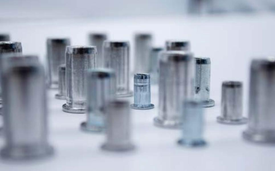
Blindnietmuttern und Blindniet-schrauben eignen sich zur Ein- und Anbringung von tragfähigen Innen- oder Außengewinden in dünne Bauteile. Sie ermöglichen die feste Verbindung zweier Bauteile und die lösbare Anbringung weiterer Bauteile.
