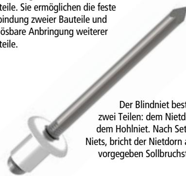
Der Blindniet besteht aus zwei Teilen: dem Nietdorn und dem Hohlniet. Nach Setzen des Niets, bricht der Nietdorn an einer vorgegeben Sollbruchstelle ab.
