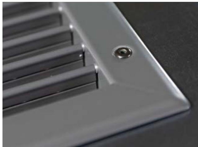
Blindniels in dieses Loch, befindet sich der Setzkopf auf der Verarbeitungsseite des Bauteils und der Hohlnietschaft auf der blinden Seite. Daraufhin wird der Niet mit Hilfe eines speziellen Blindniet-Setzgeräts in Position gehalten. Um den Niet zu verformen und die Verbindung herzustellen, wird das Setzgerät ausgelöst. Dies bewirkt, dass der Schaft des Niets durch den Schließkopf zusammen- und der Setzkopf gegen das Bauteil gedrückt wird. Der Hohlnietschaft wird durch
