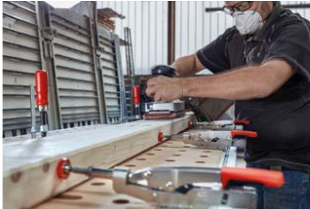
Teamwork für den sicheren Halt: Schnellspanner der Serie STC in Kombination mit Ganzstahl-Tischzwingen mit Holzgriff (GTR).
