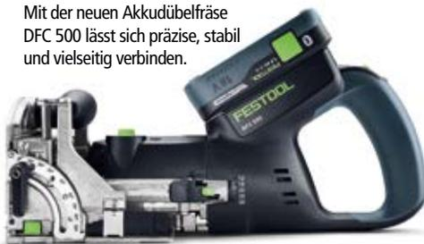
Bei Handmaschinen einzigartig: Die Fräsbewegung der Domino Dübelfräsen. Das gleichzeitige Drehen und Pendeln des Fräsers ermöglicht leichtgängiges Arbeiten und erzeugt ein präzises Langloch. Durch die Pendelbewegung überhitzen die Fräser nicht, was zu einer extrem hohen Standzeit führt.
