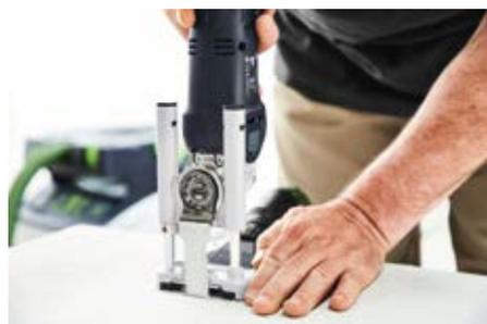
Ansetzhilfe: Für exakt geführte Eintauchsnitte. Mit integriertem Tiefenanschlag und Absaugstützen.
