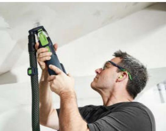
Absaugvorrichtung: Für staubarmes Sägen und freie Sicht auf das Werkstück. Ideal für Sägearbeiten über Kopf. (Fotos: Festool)
