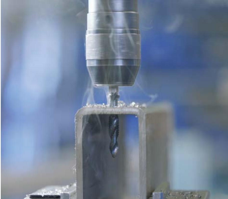
Drei Arbeitsgänge mit einem Werkzeug: Bohren, Gewindeschneiden, Entgraten.
