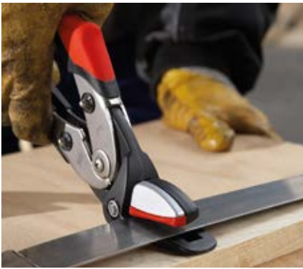
Bandeisen lassen sich mit der Spezialschere schnell und sicher durchtrennen. Dabei wird das Bandeisen beim Schnitt festgehalten.
