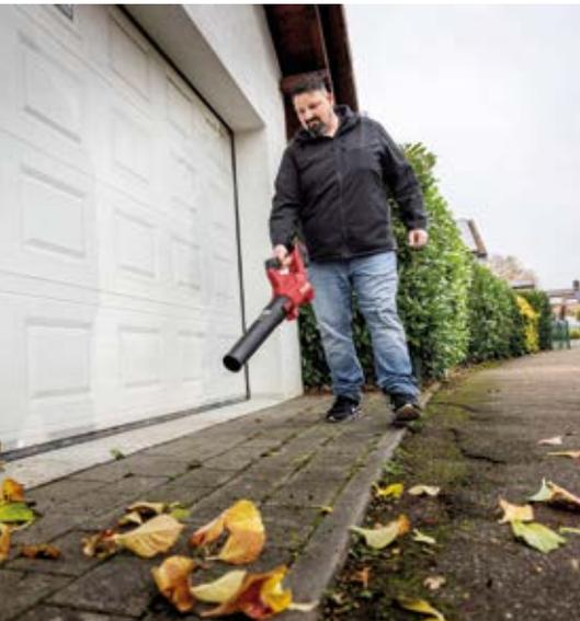
einem 2,4 mm Faden ausgestattet. Er bietet aktuell die höchste Schnittgeschwindigkeit in dem Segment. Der Flex Laubbläser ist mit nur 1,8 kg aktuell der leichteste seiner Klasse. Gleichzeitig verfügt er jedoch mit 790 m<sup>3</sup>/h Luftvolumen ebenfalls über den längsten „Atem“ in seinem Segment.
