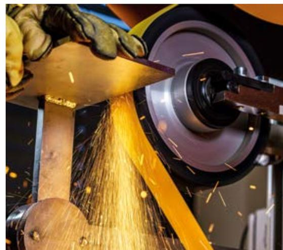
Neben verbesserter Schleifleistung und längerer Standzeit sorgt RazorStar® auch für einen kühleren Schliff. Dafür wird das scharfkantige Korn durch eine spezielle Beschichtung ergänzt, die die Wärmeentwicklung während des Schleifvorgangs erheblich reduziert. Ein weiterer Vorteil: Dank der längeren Standzeit der RazorStar-Schleifbänder kann deren Verbrauch und damit das Volumen der zu entsorgenden Schleifbänder signifikant reduziert werden. (Fotos: Saint-Gobain Abrasives GmbH)
