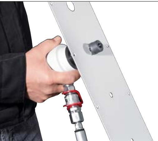
Durchbrüche mit Blechlocher und hydraulischen Betätigungshilfen erleichtern Schaltschrankbauern den Alltag. (Fotos: RAS/Alfra)
