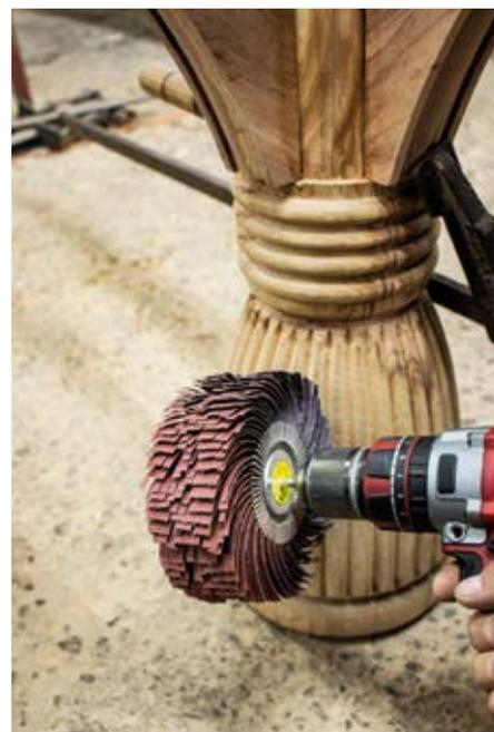
bindung befestigt sind. Diese Blocks werden dann in ein Spannfutter eingespannt und ergeben so einen runden Schleifkörper, der sich für einen vielseitigen Gebrauch auf Handmaschinen oder auch auf ortsfesten Maschinen eignet.“ ■
