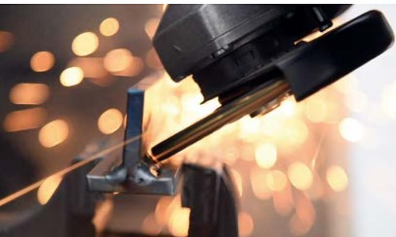
Schleifen mit der Kante: Der Lukas-Kehlnahtschleifer U-Edge Pro in Tellerform erleichtert das Bearbeiten von Kehlnähten.
