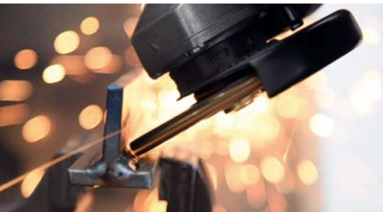
Der U-Edge Pro ist mit seiner auf der Kante positionierten Schleiffläche für die Schweißnahtbearbeitung konzipiert und macht den Einsatz von Schruppscheiben und Schleiftellern zur Schweißnahtbearbeitung überflüssig. (Foto: Lukas)
