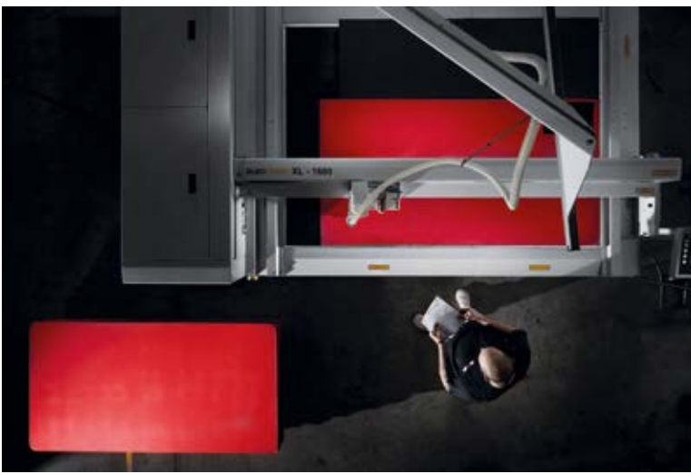
Die Laserschneidanlage zur Bearbeitung der Schaumeinlagen. W.AG bietet unterschiedlichste Lösungen für die Individualisierung der Schaumeinlagen zum sicheren Transport der Werkzeuge an. (Fotos: André Druschel)
