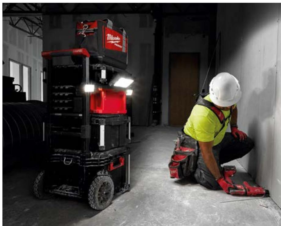
können. Die Lithium-Ionen-Akkus werden in der Lampe über einen Mikro-USB-C-Anschluss aufgeladen.
