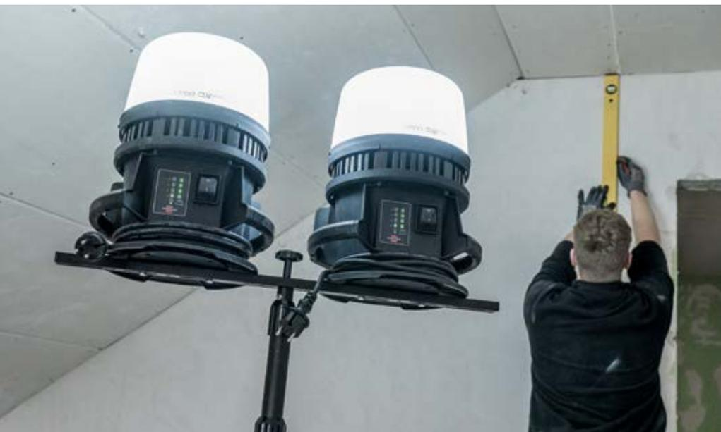
Vorteilhaft für die gleichmäßige Ausleuchtung von Baustellen ist oft eine 360 Grad Ausleuchtung. Brennenstuhl hält entsprechende Leuchten im Multi Battery 18V System auch als Hybrid-Strahler bereit. (Fotos: Brennenstuhl)
