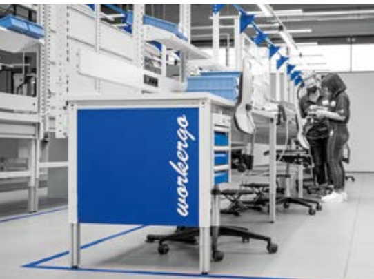
Das ergonomische Arbeitsplatzsystem Workergo von Bedrunka + Hirth, hier in der eingesetzten 4-Fuß-Version, bietet drei verschiedene Formen der Höhenverstellbarkeit.
