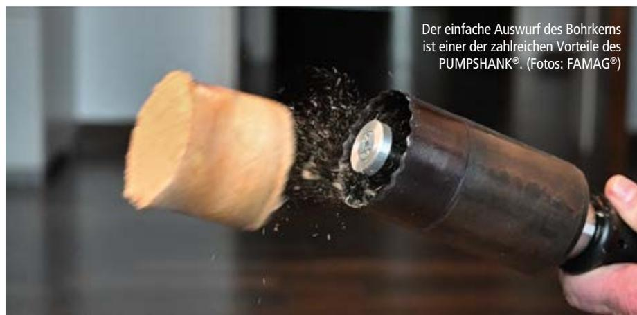
Der einfache Auswurf des Bohrkerns ist einer der zahlreichen Vorteile des PUMPSHANK®. (Fotos: FAMAG®)
