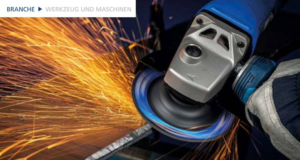
Die CC-Grind Robust überzeugt im Einsatz da, wo sonst Schruppschleifscheiben zum Einsatz kommen, weil sie deutliche Vorteile liefert. (Fotos: Pferd)
