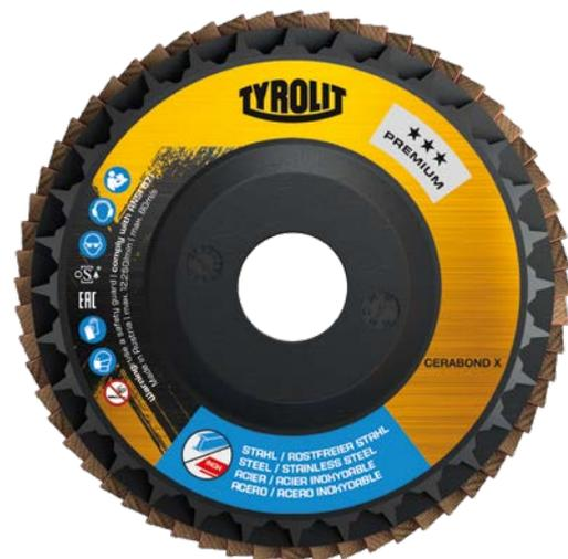
Die Cerabond X Fächerscheiben überzeugen mit Leistungsstärke und Langlebigkeit. Im Vergleich zu den Vorgängertypen bieten sie um rund 30 Prozent mehr Abtrag. Ermöglicht wird dies durch die Verwendung eines keramischen Kornes in Verbindung mit einem innovativen Bindungssystem. (Fotos: Tyrolit)
