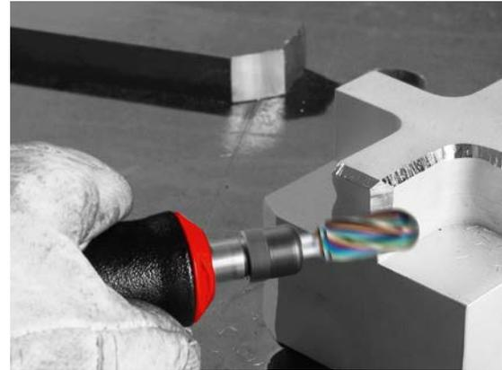
Dank der LightFlow-Beschichtung setzen sich Fräser nicht bzw. nicht so schnell mit z.B. abgefrästen Aluminiumspänen zu. Die LightFlow-Beschichtung ist auch für die Zerspannung von Grafit, Kupfer, Carbon und Holz geeignet.
