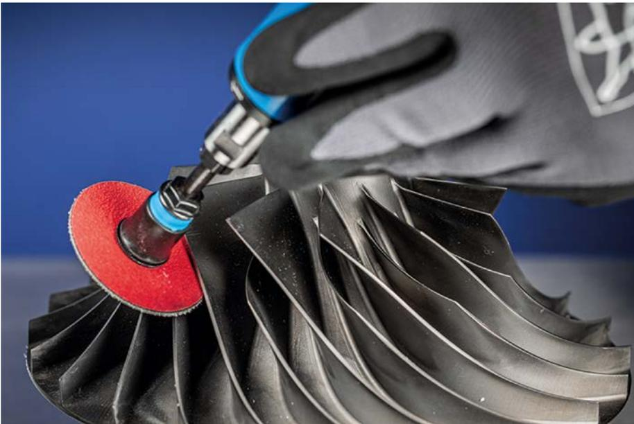
Für das Beschleifen von rückwärtigen Reparaturschweißungen ideal geeignet: Combidisc-Schleifblätter der Ausführung RS. (Fotos: Pferd)
