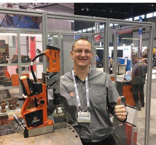
Die FEIN KBU 35 PQ ist mit einem robusten 1.010-Watt-Hochleistungsmotor ausgestattet. Die integrierte Tachoelektronik trägt zur Stabilisation der Drehzahlen unter Last bei. Der Motor lässt sich stufenlos und komplett ohne Werkzeug durch den Bohrmotor-Klemmhebel verstellen, wodurch der Hubbereich erweitert oder je nach Anwendung verringert wird.
