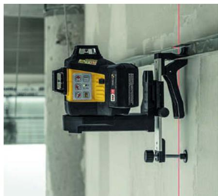
Plus beim Zubehör der neuen Multilini-Laser LAX 600 und LAX 600 G zur flexiblen Positionierung auf eine gewünschte Arbeitshöhe: die Universalhalterung SUB 10 (mit 1/4"- und 5/8"-Gewinden zur Befestigung auf Stativen, mit Seltenerd-Magneten) und die Wandhalterung SWB 10 (mit Grob- und Feinjustage für die Ausrichtung der horizontalen Laserlinie).
