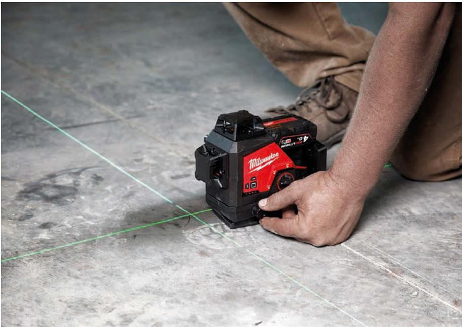
Für eine einfache und vielseitige Ausrichtung verfügt jeder der Kreuzlinienlaser von Milwaukee über eine Feinjustierung, die eine schnelle Punkt-zu-Punkt-Ausrichtung ermöglicht. (Milwaukee)
