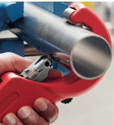
Der Knipex TubiX XL Rohrabschneider ist zum Schneiden von Kupfer-, Messing- und Edelstahlrohren mit einer Wandstärke bis 2 mm und einem Durchmesser von 6 bis 76 mm (1/4" - 3") geeignet. (Foto: Knipex)
