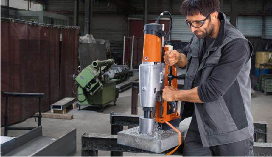
Hohe Motorkräfte und viel Hub erfordern bei der Magnet-Kernbohrmaschine FEIN KBU 110-4 M eine noch höhere Magnethaltekraft der Maschine. Dafür sorgt der Magnet mit einer Haltekraft von 23.000 Newton. Zusätzlich dazu hat die Maschine eine integrierte Drehmomentstütze, die den Kippunkt der Maschine weiter nach hinten verlagert.
