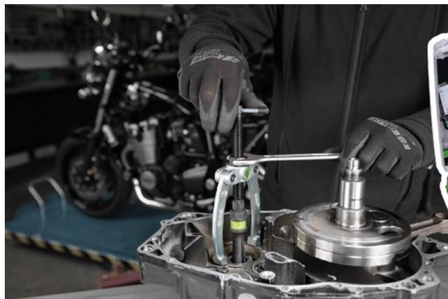
In Kombination mit einer Gegenstütze (Art.-No. 22-1) lassen sich innenliegende Bauteile mit einem Innenauszieher (Art.-No. 21-4-E) entfernen.
