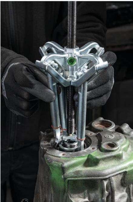
Mit dem PULLPO können Kugellager zerstörungsfrei demontiert werden, um sie erneut zu verwenden.
