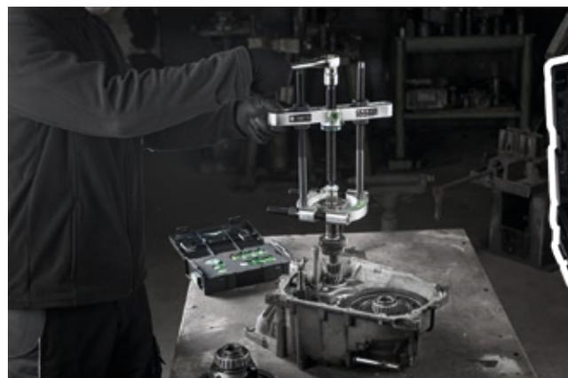
Wenn ein Bauteil plan aufsitzt, wird für den Abziehvorgang eine Trennvorrichtung (Art.-No. 15-2) in Kombination mit einer Abziehvorrichtung (Art.-No. 18-2) benötigt.
