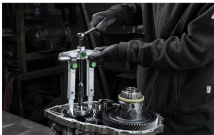
Mit einem 2-armigen Universalabzieher (20er Serie) kann ein Kugellager mühelos von einer Welle abgezogen werden.
