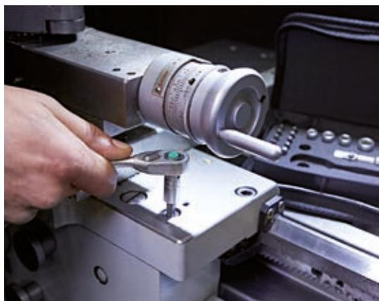
Die 80-zahnige Knarre mit extra-schlankem Stahlgriff bietet einen Arbeitswinkel von nur 4,5 Grad – ideal für Arbeiten in engen Zwischenräumen. (Foto: Stahlwille)
