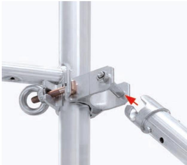
Der Ausleger mit Bajonett-Verschluss kann vom Boden aus montiert werden. Er ist anklappbar, damit vom Gerüst aus so nah wie möglich an der Wand gearbeitet werden kann.
