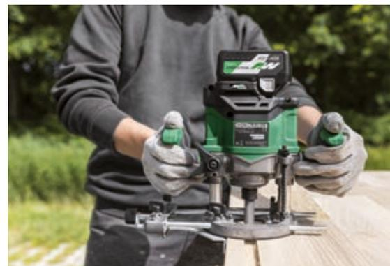
Das ergonomische Design garantiert bei der Akku-Oberfräse M3612DA von Hikoki eine genaue Führung. Fräsen, Schneiden, Nuten und Abkanten sind damit auch außerhalb der Werkstatt flexibel möglich. (Foto: Hikoki)
