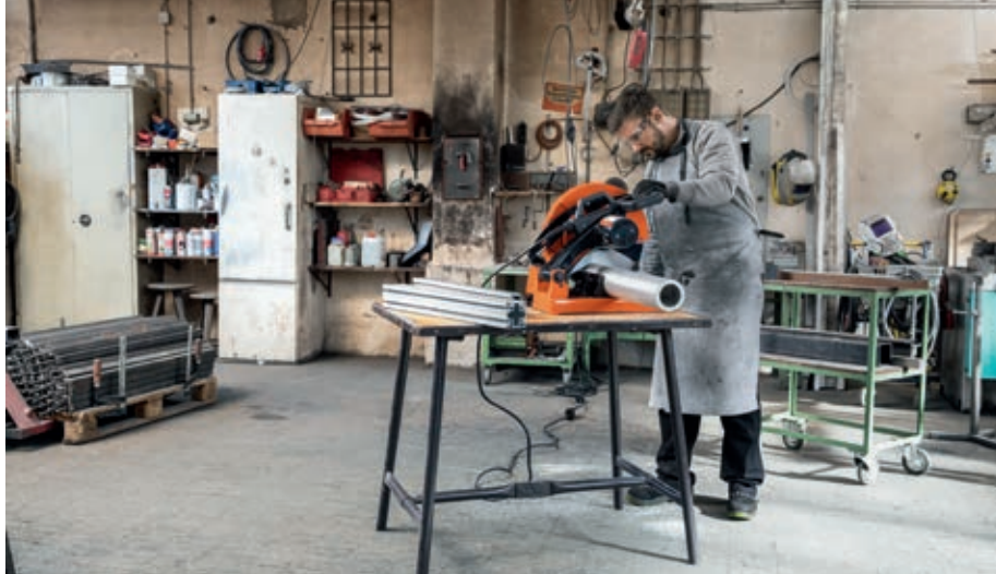
Trenn- und Gehrungsschnitte in Metall erledigt die neue Fein Kappsäge MKAS 355 bei maximalem Arbeitsfortschritt ohne Metallstaubbildung und je Material auch ohne Funkenflug. (Fotos: Fein)
