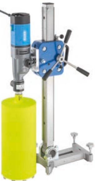
Maschine angeschlossen wird. Dieser saugt durch die Bohrkronen sowohl das Bohrmehl ab als auch die entstehende Hitze im Bohrloch. Auch dies trägt dazu bei, dass die Diamantsegmente nicht zu heiß werden. Die Diamant-Trockenbohrmaschinen bohren dadurch problemlos selbst in Stahlbeton ohne Wasser, ohne Staub und ohne hohe Rüstkosten. Baier bietet verschiedene Profi-Lösungen für das Trockenbohren – hand- oder ständergeführt, spezialisiert oder vielseitig.
