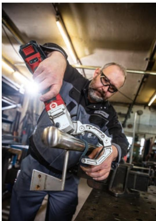
Das Trinox-System für die Metallbearbeitung nutzt einen Basisantrieb für vier verschiedene Aufsätze.
