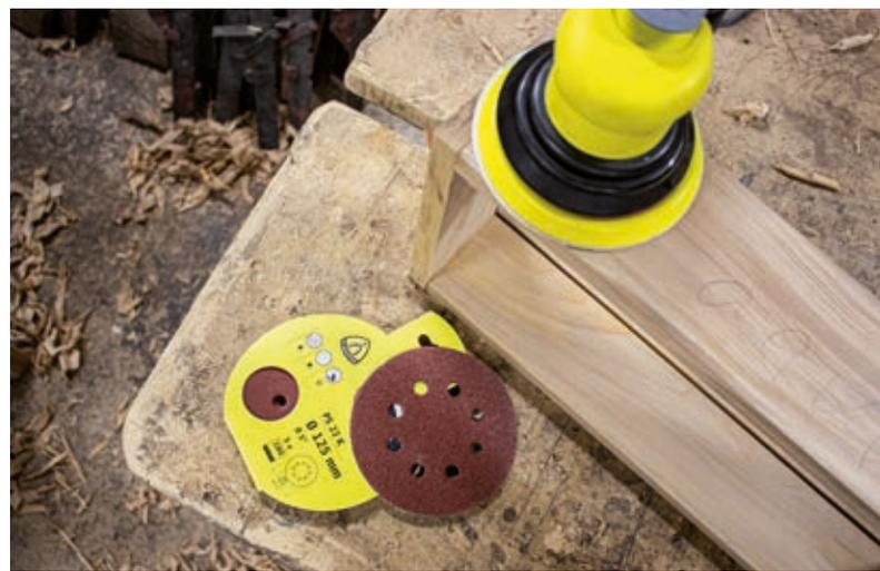
Neben der Körnung und dem Schleifmittel ist bei Schleifscheiben für den Exzenter-schleifer auch die passende Lochung wichtig.
