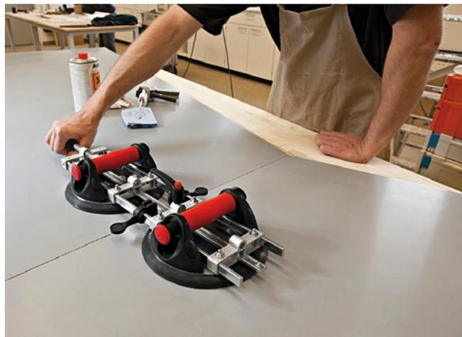
Mit dem Plattenspanner PS130 bietet BESSEY Handwerkern eine optimale Lösung zum Verspannen und Positionieren großflächiger, auch schwerer Bauteile mit glatter Oberfläche. (Fotos: BESSEY)
