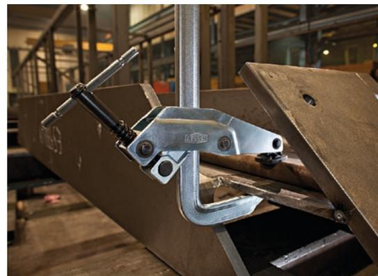
Ist das Werkstück schwer zugänglich und wenig Platz vorhanden, darf der Griff der Zwin- ge nicht im Weg sein. So befindet sich beispielsweise bei der Greifarm- zwin- ge GRA der Knebelgriff hinter der Schiene.
